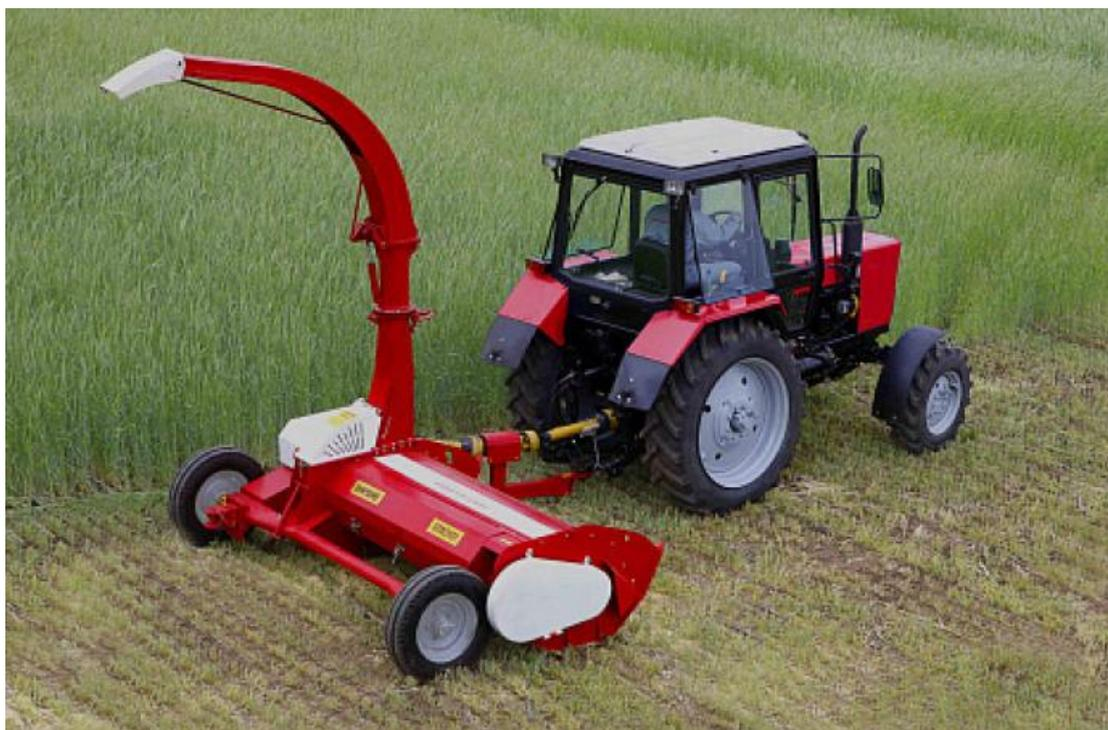
Рисунок 1.2 - Прицепной кормоуборочный комбайн STERN 2000
