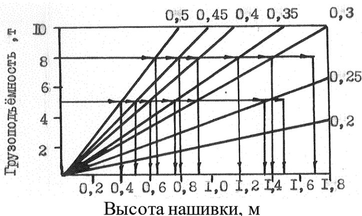
Рисунок 3.2. Номограмма для определения высоты нашивки кузовов прицепов в зависимости от объемного веса зеленой массы кукурузы.
