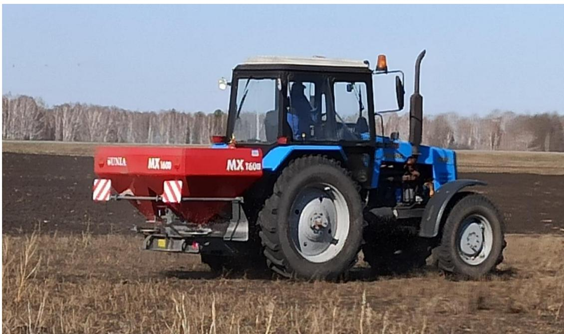
Рис. 1. Разбрасыватель минеральных удобрений (Unia 1600)
