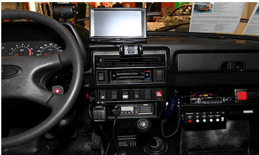
Рис. 5.8. Бортовое оборудование передвижного объекта
