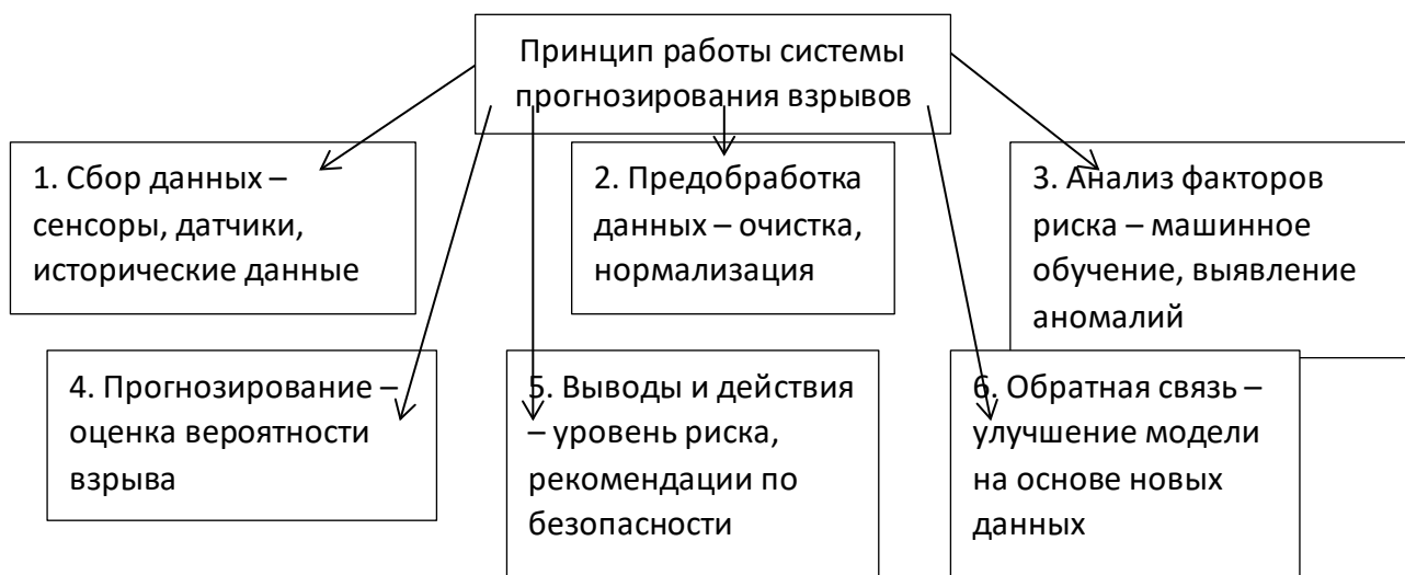
Рисунок 1. Принцип работы системы прогнозирования взрывов
