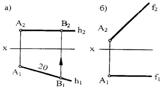
2.8 Построить проекции отрезка АВ длиной 20 мм, проходящего через точку А и перпендикулярного плоскости: б) П1; в) П3.
