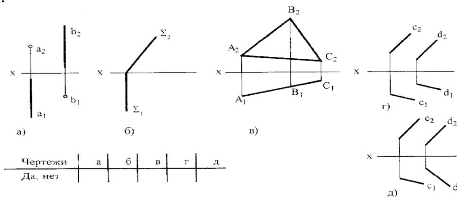
3.2. Определите расположение плоскостей относительно плоскостей проекций
