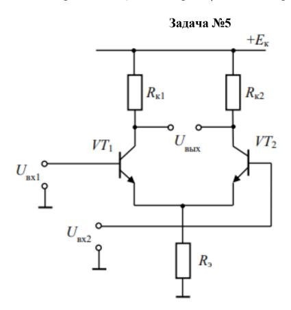
В дифференциальном усилительном каскаде (рисунок)  $R_{\kappa 1} = R_{\kappa 2} = 1$  кОм,  $R_{\mathfrak{I}} = 10$  кОм. Используются одинаковые транзисторы  $VT_1$  и  $VT_2$ , у которых  $\beta = 100$ ;  $r_{\mathfrak{I}} = 100$  Ом. Найти выходное напряжение  $U_{\text{вых}}$ , если  $U_{\text{вх}1} = 1$  В,  $U_{\text{вх}2} = 1,2$  В
